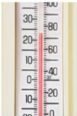
O termômetro apresentado marca à esquerda graus Celsius e à direita graus Fahrenheit. Vale ressaltar que a temperatura de congelamento da água é  $0^\circ$  Celsius e  $32^\circ$  Fahrenheit. Por outro lado, a temperatura de ebulição da água é  $100^\circ$  Celsius e  $212^\circ$  Fahrenheit.
